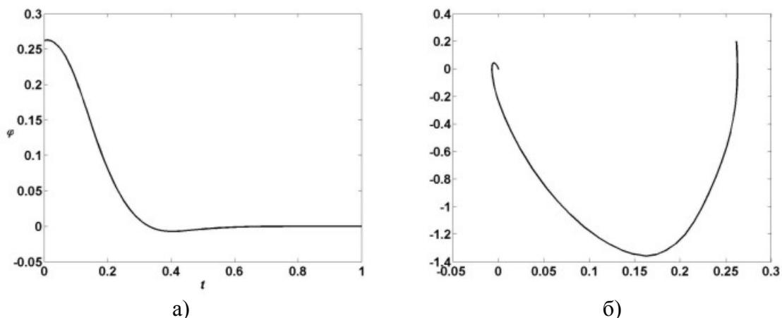
Рис. 8. График зависимости курса судна от времени и фазовая траектория.
