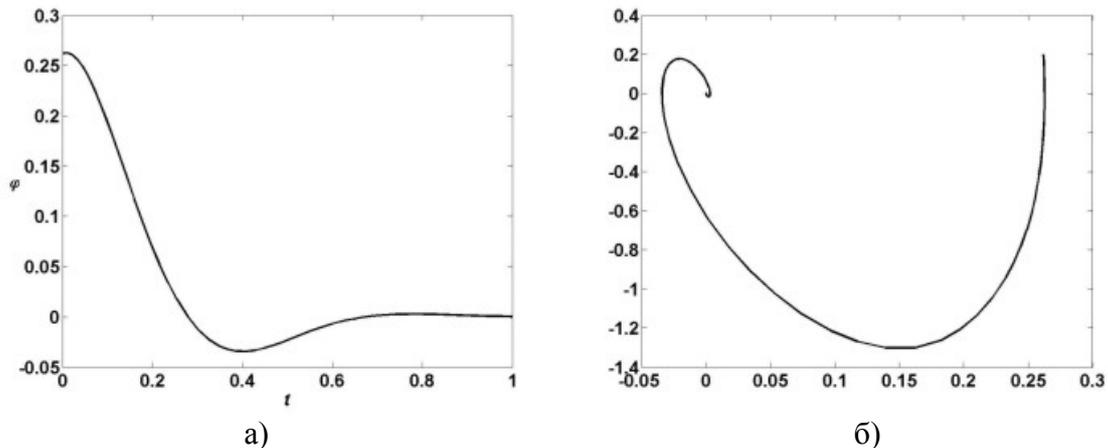
Рис. 7. График зависимости курса судна от времени и фазовая траектория.
