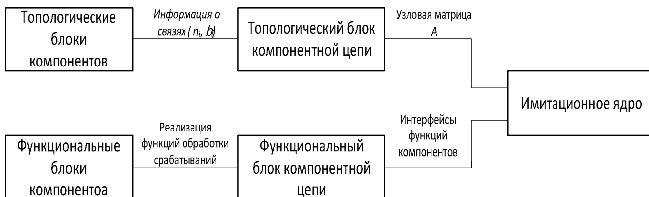
Рис. 4. Структура алгоритмических компонентов и их связь с имитационным ядром.
