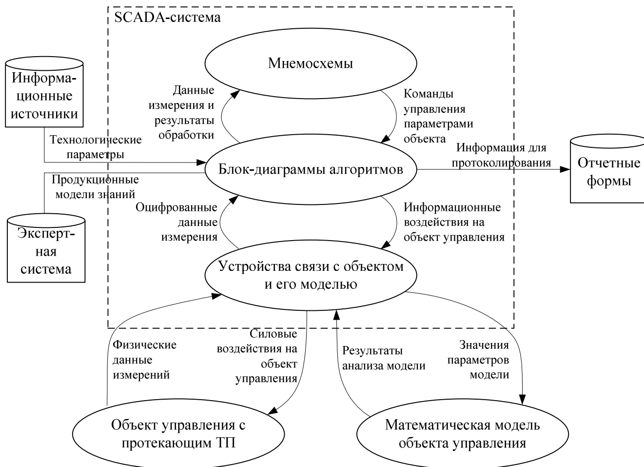
Рис. 1. Архитектура компьютерной модели SCADA-системы с математической моделью в контуре управления.
