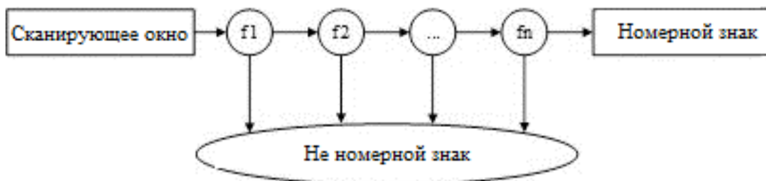
Рис. 4. Каскад классификатора в цепочке фильтров.
