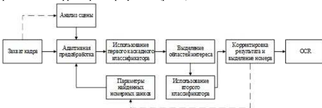
Рис. 8. Модификация алгоритма локализации НЗ ТС с последовательной работой классификаторов.
