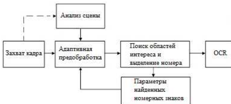
Рис. 5. Алгоритм локализации НЗ ТС с использованием адаптивной предобработки и признаков Хаара.
