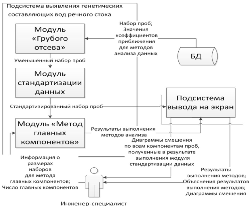
Рис. 4. Структура подсистемы обработки данных.
