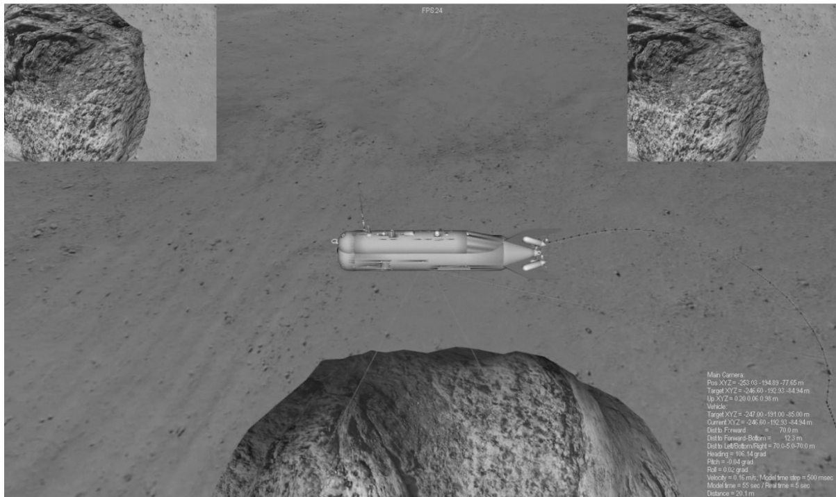
Рис. 2. Восстановление траектории движения методом визуальной навигации. Реальная траектория ПР и вычисленное положение очень близки.
