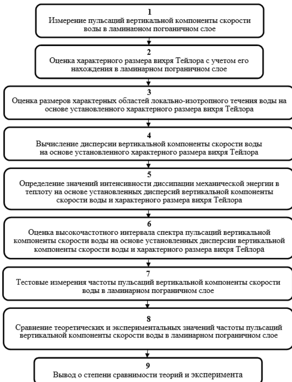
Рис. 1. Структурная блок-схема предлагаемого метода определения высокочастотного интервала спектра пульсаций вертикальной компоненты скорости в ламинарном пограничном слое турбулентного потока воды.
