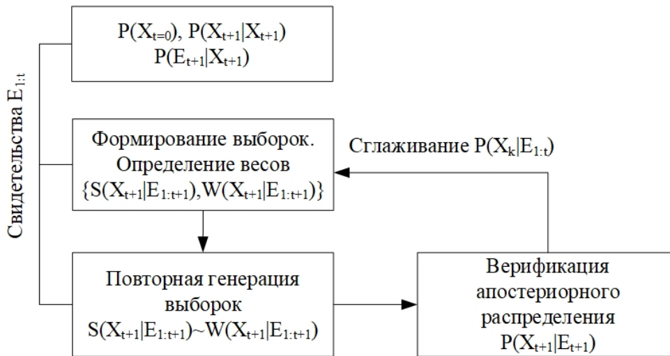
Рис. 2. Типовая схема МЧФ-фильтра с ВП.
